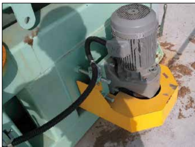
図表4 モーター回転部をカバーで養生
