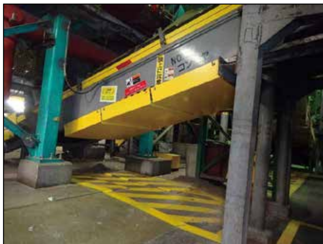
図表4 モーター回転部をカバーで養生
