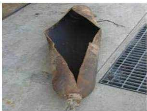
【写真】破裂した容器の例（県撮影／高圧ガス保安協会ホームページからの引用）
